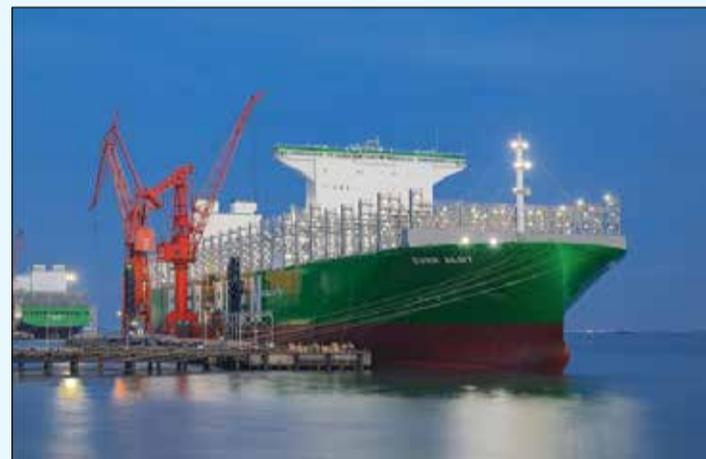
de la China State Shipbuilding Corporation, avec des droits de propriété intellectuelle totalement indépendants. Le navire mesure 399,99 mètres de long, plus de 60 mètres de plus que le plus grand porte-conteneurs au monde et 61,5 mètres de large, avec une surface de pont de 24.000 mètres carrés, soit l'équivalent de 3,5 terrains de football standard.
